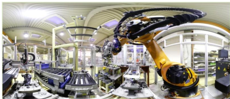
Abb. 48: Montageanlage Anbauteile Bremse (Quelle: Gluth Systemtechnik GmbH)
