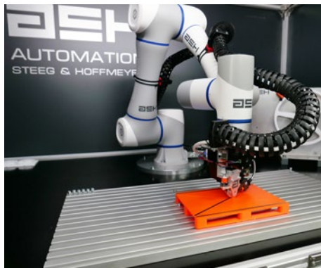
Tapeverstärkung am Beispiel einer Palette
