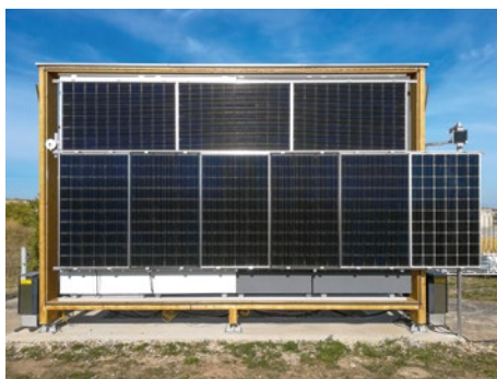
Outdoor-Teststand für Fassadenintegration
