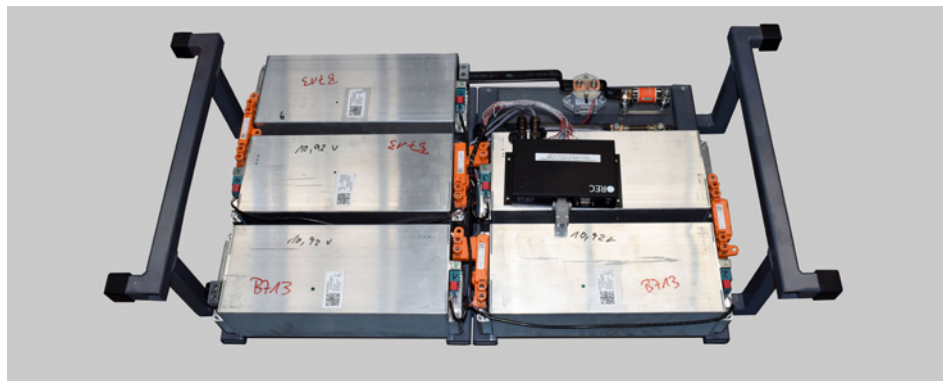
Rack-Einschub mit Einzelmodulen
