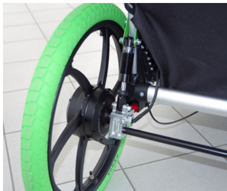
bürstenloser Radnabenmotor, hydraulische Federung
