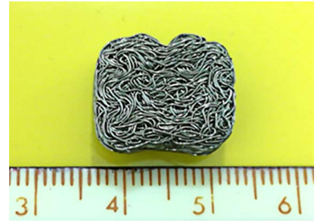
Bandscheibenprothese aus Titangestrick als Dämpfungselement im Halswirbelsäulenbereich
