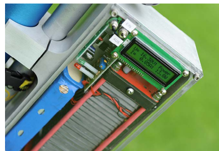
Brennstoffzellen-Stapel mit Steuerungsmodul
