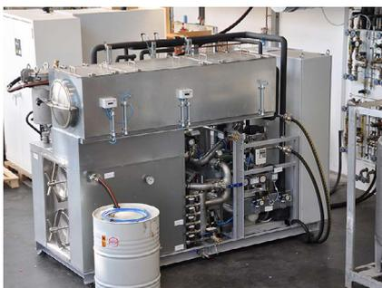
Technikumsanlage zur Phasentrennung am Zentrum für Energietechnik
