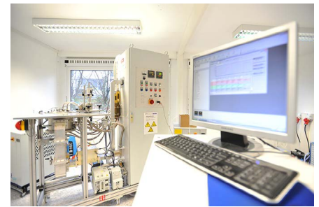
Labormikrowellenofen im Technikum der JPM Silicon GmbH
