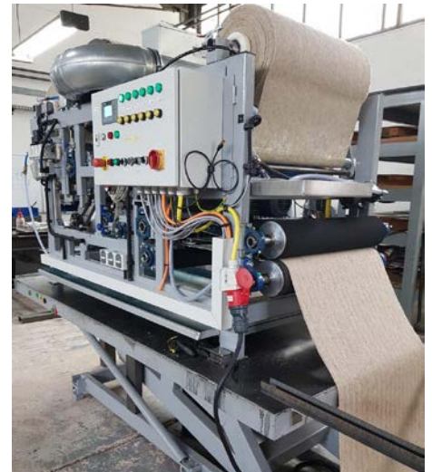
Produktion der Vegetationsmatte zur Begrünung von erosionsgefährdetem Gelände
