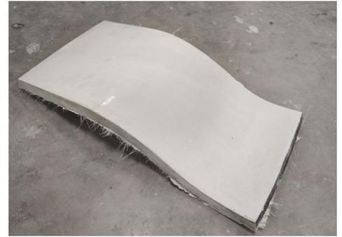
Einfach gekrümmte Elemente können bis zu einem Krümmungsradius von 100 mm ohne Formabweichungen umgeformt werden.
