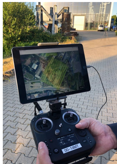
Fernsteuerung zur Überwachung des Fluges und der Aufnahmen
