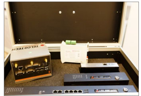
IPSS-Router und Router Bridge
