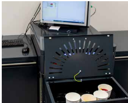
Farbmischmaschine mit Rezeptursoftware und punktgenauer Dosierung der Farbe
