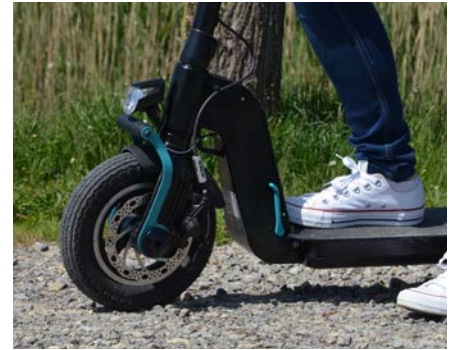
Robuste mechanische Ausführung mit großen Reifen und Scheibenbremse
