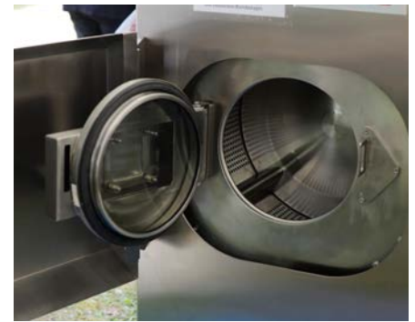
geöffnete Trommeltür mit besonderer Abdichtung und Absaugung
