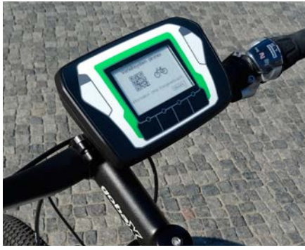
piBike-HMI – innovativer Boardcomputer für Fahrradverleihsysteme
