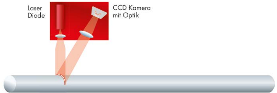
Das Prinzip der Laser-Lichtschnittmessung: Die Laserdiode projiziert quer zur Transportrichtung eine Laserlinie auf das Objekt, die Kamera zeichnet die Laserlinie auf.
